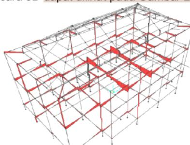
Gambar 2. Pemodelan Struktur 3D
