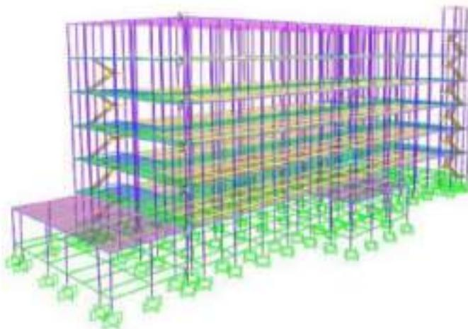
Gambar 1. Cek Simpangan Antar Lantai Dibagian Joint Pojok
