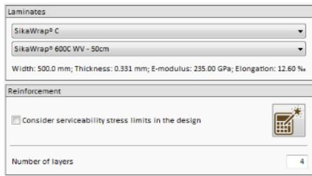
**Gambar 12.** Jenis Perkuatan CFRP pada Kolom
