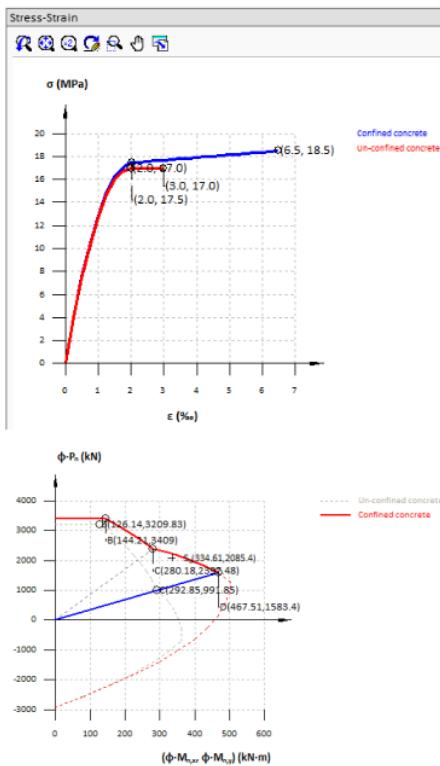
**Gambar 15.** Diagram Interaksi dan Diagram Tegangan Regangan Setelah Perkuatan Kolom
