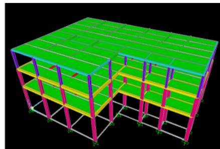
**Gambar 3.** Permodelan dengan SAP 2000 v14.25
