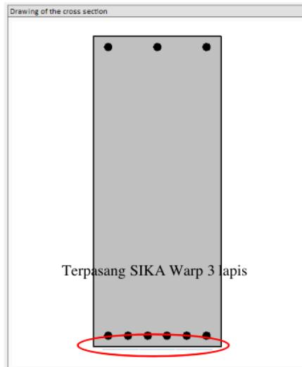
Gambar 7. Balok Dengan Perkuatan SIKA Warp 3 Lapis
