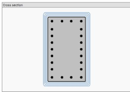
**Gambar 13.** Penampang Kolom dengan Perkuatan SIKA Warp
