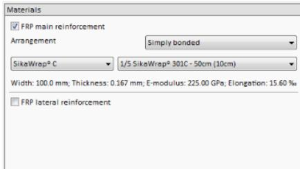
Gambar 6. Jenis Perkuatan CFRP
