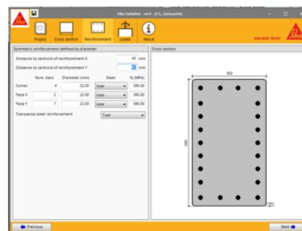
**Gambar 10.** Permodelan Kolom pada SIKA CarboDur
